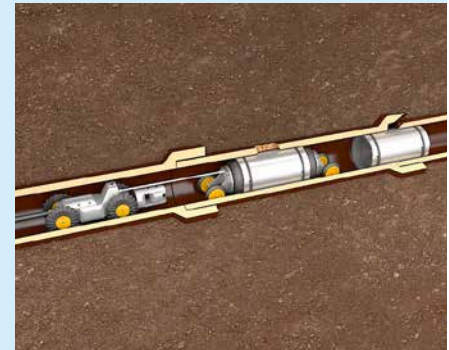
Innenmanschetten Positionierung der Manschette mit dem Kamerawagen (nur bedingt ein- setzbar, da nur sehr eingeschränkt bogengängig)
